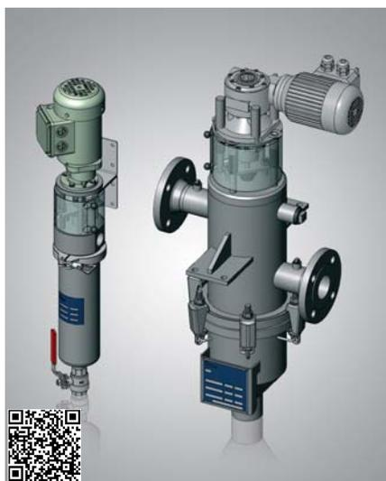
Die selbstreinigenden Filter der Serie KSF bestehen aus einem Ober- und einem Unterteil. Beide Teile werden mit einem Schnellspannbügel bzw. Klammerschrauben fest miteinander verbunden. Der Ein- und Austrittsstutzen ist ab der Serie KSF400 höhenversetzt und gegenüberliegend angeordnet. Der Austrittsstutzen ist höherliegend angeordnet.
