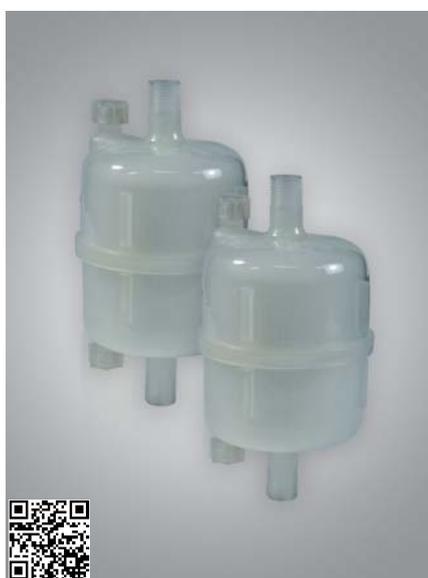
Filterkapsulen mit plissierter PTFE oder PP Matrix. Speziell für kleine Filtrationsmengen konzipiert und erfordern keinen weiteren Druckbehälter. *acuraCap* Filterkapsulen werden häufig im Labor verwendet, aber auch zur Be- und Entlüftung von Behältern eingesetzt. Gehäuse und Matrix sind frei von metallischen Teilen und dank der thermischen Schweisskonstruktion frei von Klebern und Bindemitteln.
